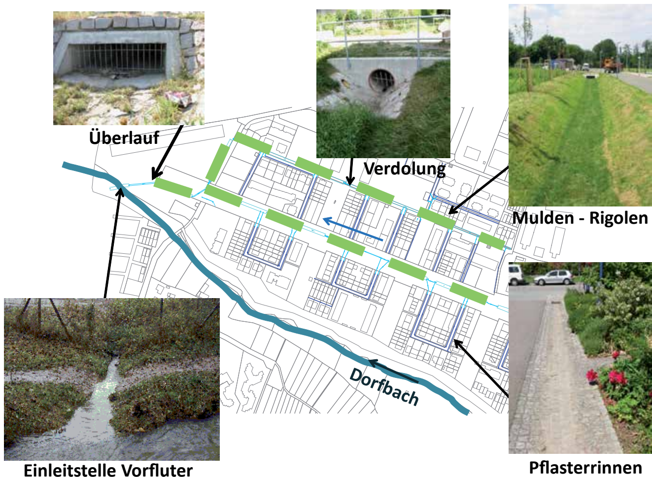
Abb. 3 Elemente des zentralen Mulden-Rigolen-Systems.
