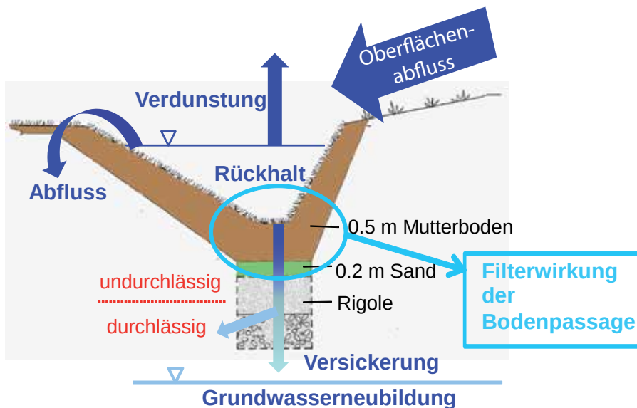
Abb. 4 Querschnitt durch Mulden-Rigole.
