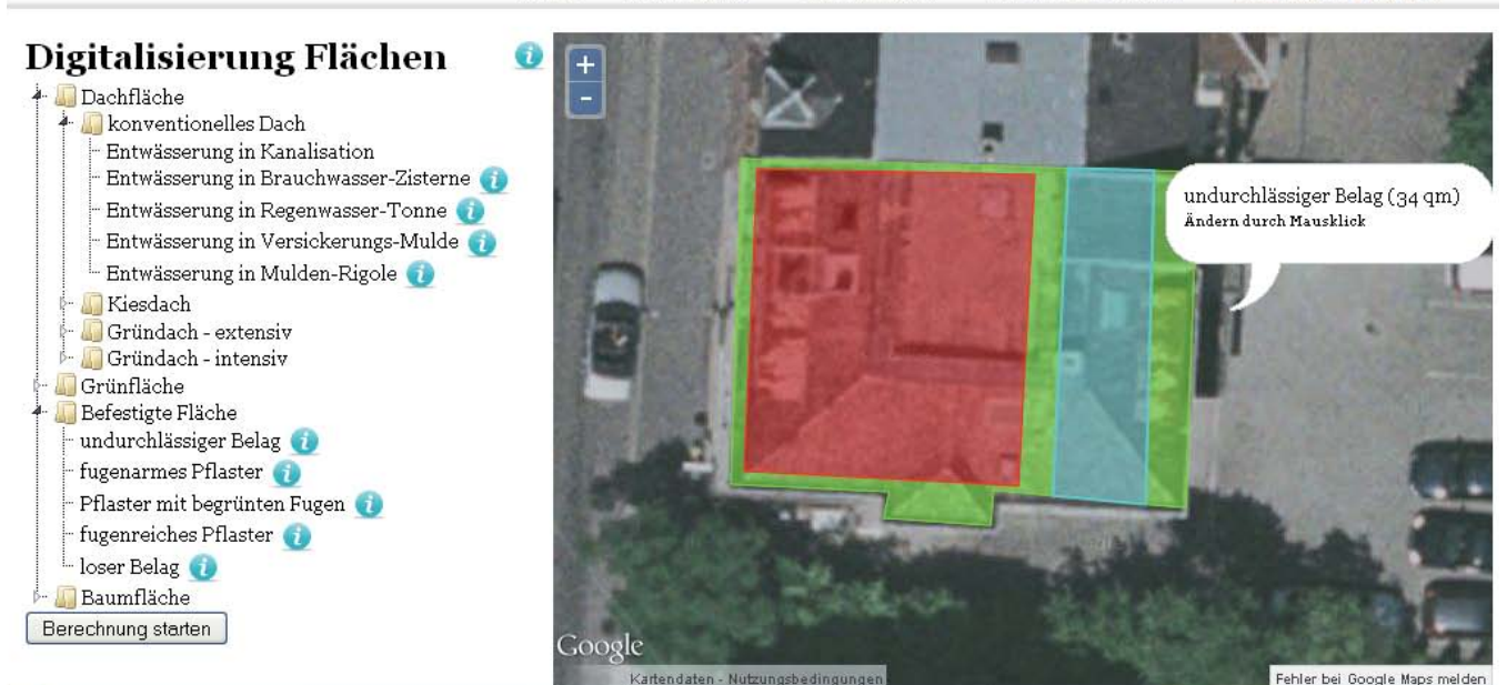
Abb. 48 Weboberflächen der neuen Webanwendung FReWaB zur Simulation der kleinräumigen Wasserbilanz und zu dezentraler Regenwasserbewirtschaftung.
