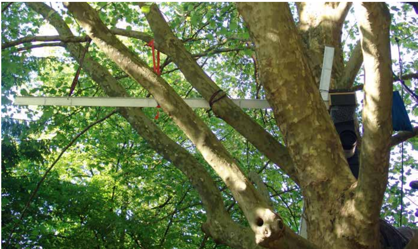
Abb. 38 Messeinrichtung zur Messung des Bestandsniederschlages unter einer Platane zur Bestimmung der Interzeption.
