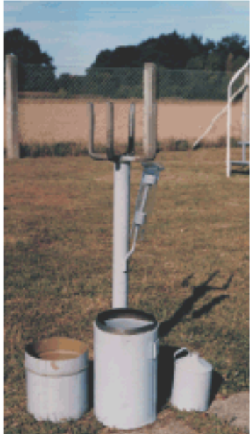
Abb. 1 Hellmann-Niederschlagsmesser Der gesammelte Niederschlag (200 cm² Auffangfläche) ist über den Meßzylinder in mm ablesbar.
