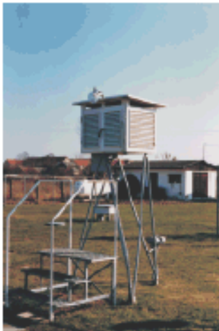
Abb. 2 Wetterhütte einer DWD-Klimastation
