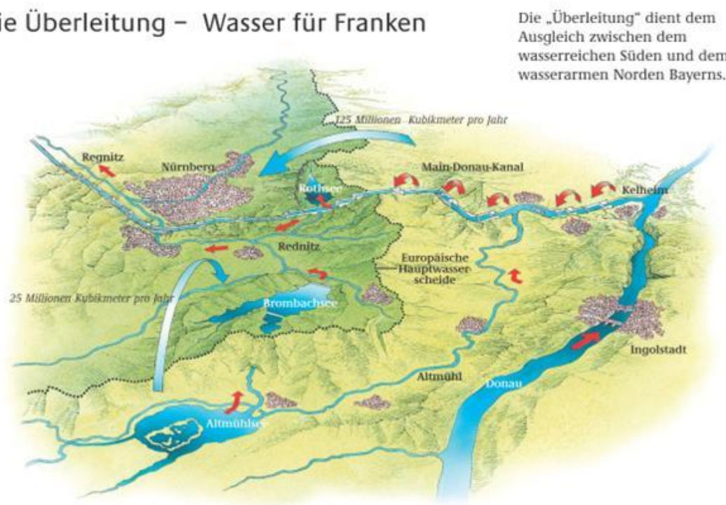
Abb. 9 Schematische Darstellung der Wasserbewegungen im Zusammenhang mit dem Main-Donau-Kanal über die Europäische Hauptwasserscheide hinweg (Wasserstraßen- und Schifffahrtsverwaltung des Bundes 2023)
