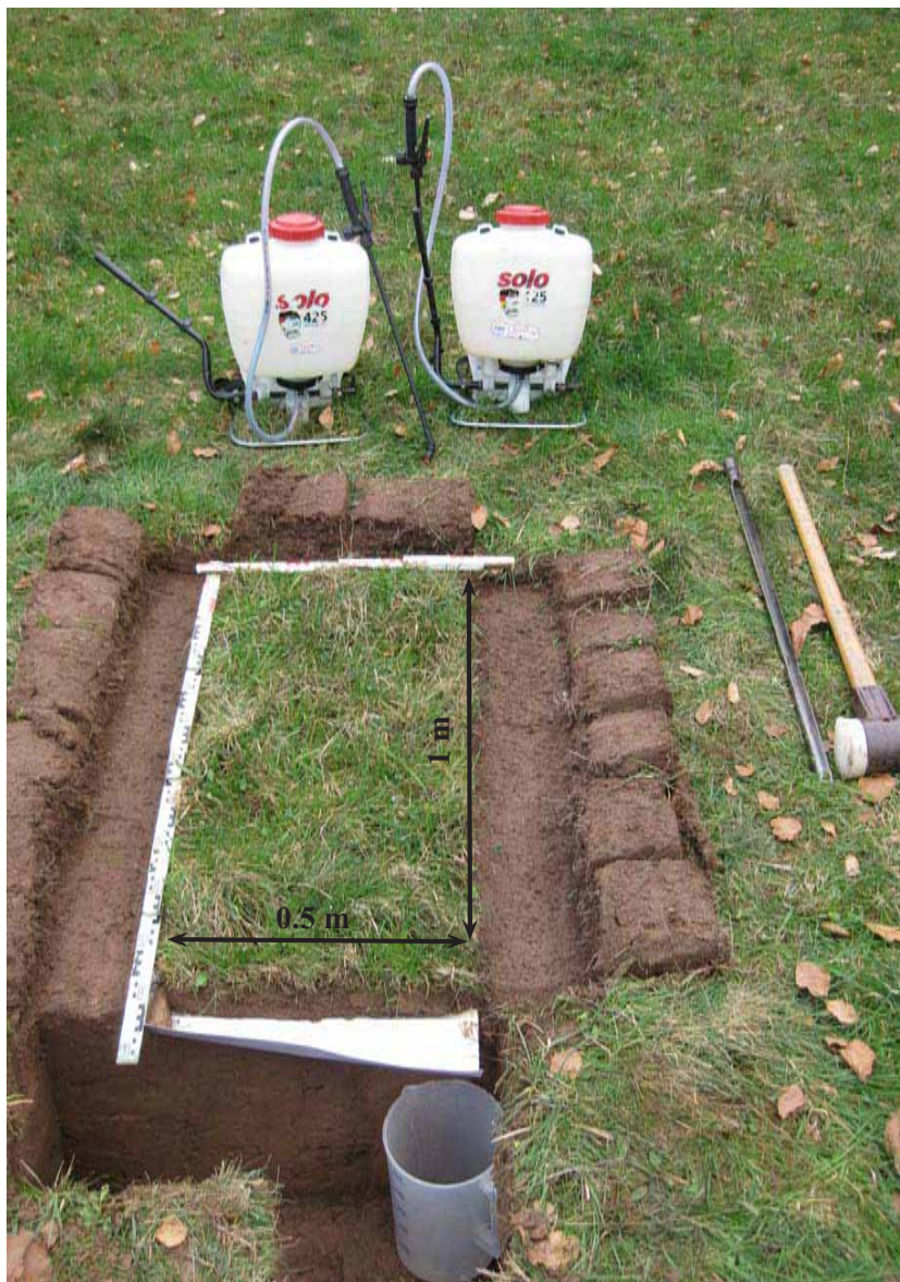
Abbildung 5.2: Aufbau eines Beregnungsversuches.
