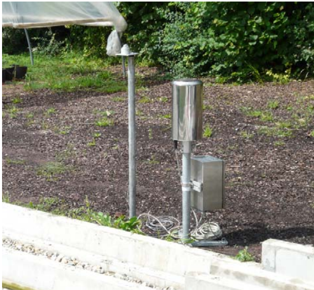
Abbildung A 3: „Klimaturm“ (Theissen) mit Pyranometer und Niederschlagswippe
