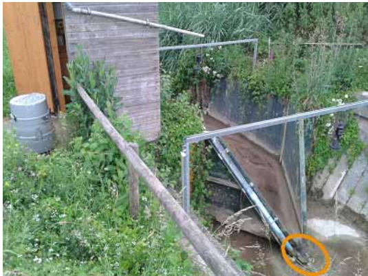
Abb. 15: Oberes Pegelhaus mit ISCO (grauer Behälter) und Ansaugstutzen (Kreis) nach dem Messwehr (2017)
