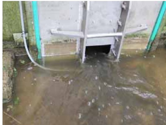
Abb. 16: Lage des ISCO-Ansaugstutzens neben dem rechten Schieber am unteren Pegelhaus (2017)
