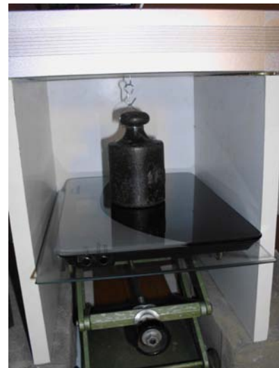
Abbildung A 4: Aufsicht und Innenansicht Versuchsaufbau für die Elastizitätsuntersuchung; die notwendige Zugkraft bewirkt ein höhenverstellbares Waagschalengewicht.
