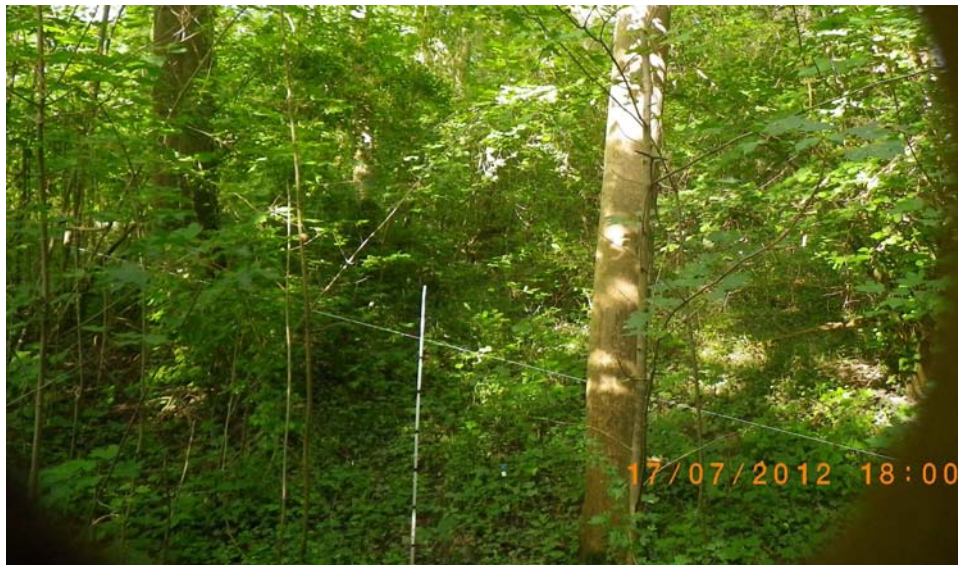
Abbildung 11: Untersuchungsfläche Standort 2 in unüberflutetem Zustand mit aufgestelltem Zollstock und Karbonfaserstäben (unten Mitte) sowie gespannter Querprofilleine.
