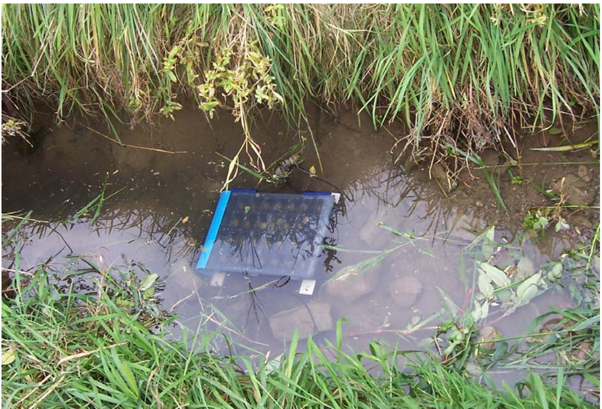
Abb. 8.6: Testsystem bestehend aus einem Sortierkasten (Freilandsystem).
