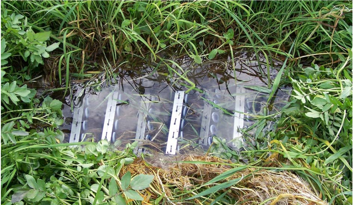
Abb. 8.5: Testsystem bestehend aus Filmdöschchen.
