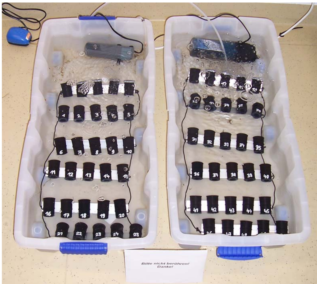
Abb. 8.8: Versuchsaufbau der Laborversuche B und C (mit Filmdöschchen-Systemen).
