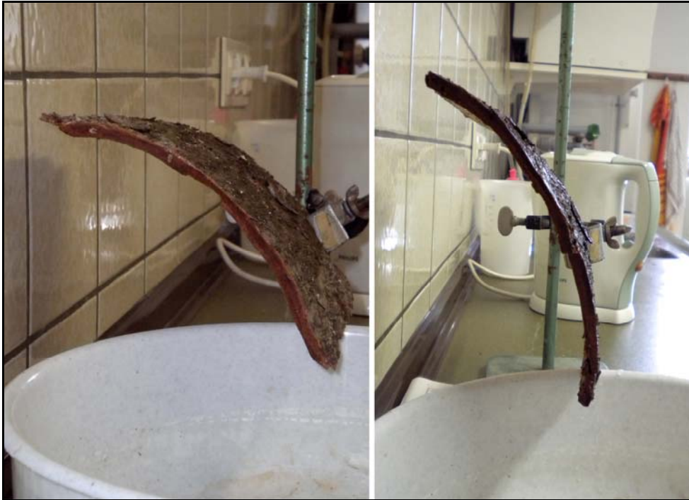
Abbildung Labv. A2: Beispielbilder zum Einspannwinkel der Rindenstücke. Links: flacher Winkel. Rechts: steiler Winkel.
