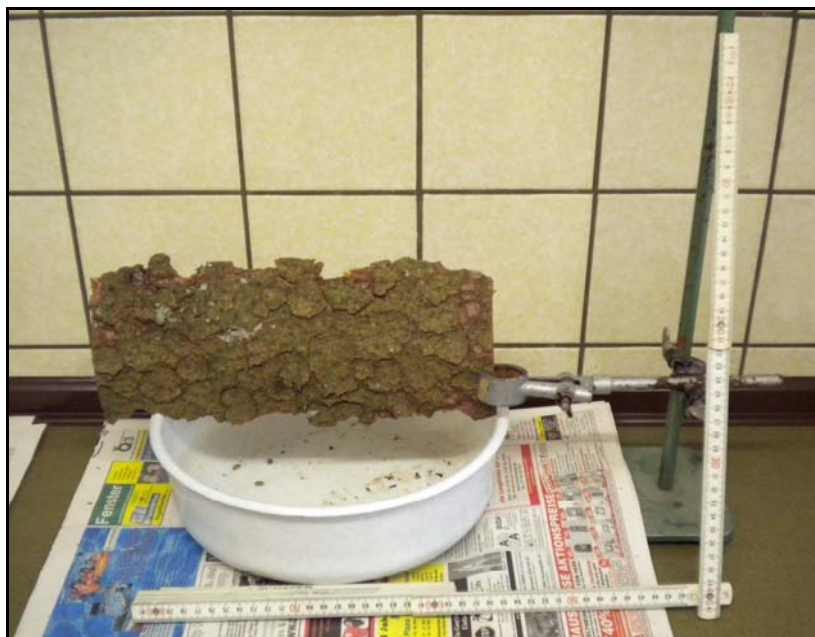
Abbildung 5.1.3: Versuchsanordnung des Laborversuchs zum Benetzungsverlust.
