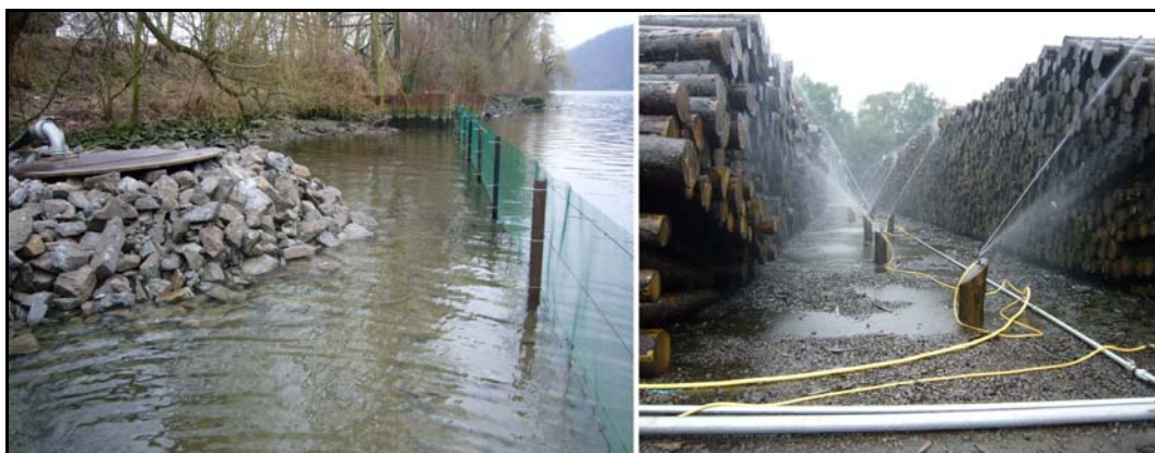
Abbildung 4.3.4: Linke Seite: Seepumpe in der Randlage des Hengsteysees. Rechte Seite: Sektorenregner in einem Fahr- und Verladestreifen (STORA ENSO, 2009).
