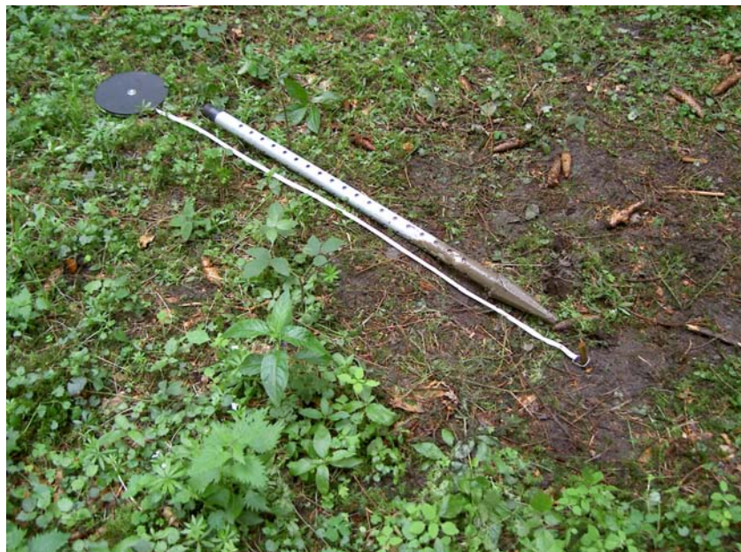
Abbildung A 4: Filterrohr zum Einbau in Riparian Zone
