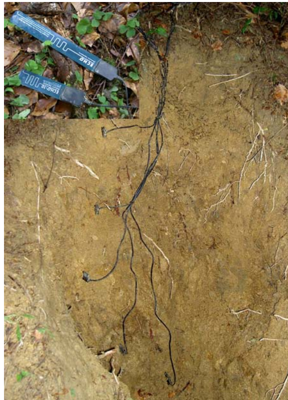
Abbildung A 6: Echo Probes Bodenfeuchtesonden (kleines Bild oben links) und deren Einbau im Bodenprofil
