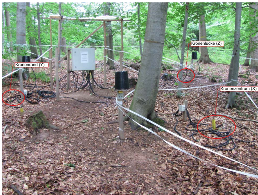
Abbildung 5: Standort je Kronenstrate X (Kronenzentrum), Y (Kronenrand) und Z (Kronenlücke) der pF-Meter Theta-Probe ML2x (Wassergehaltsmessung \theta ) Messwertgeber auf dem Buchenplot.
