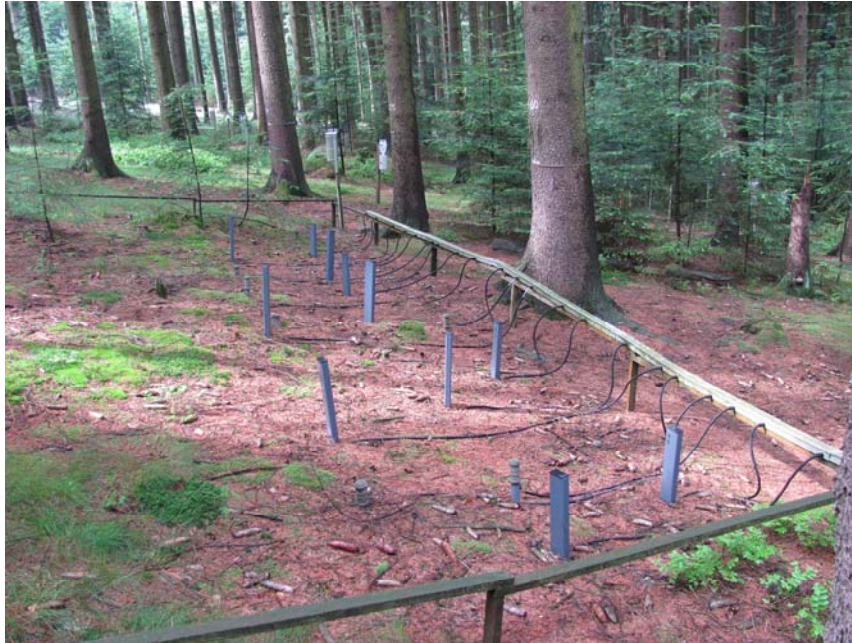
Abbildung 6: Standort der Messwertgeber für Matrixpotential \psi_m (T8-Tensiometer) und Wassergehalt \theta (Theta-Probe ML2x) der LUBW auf der Fichtenfläche in Heidelberg.
