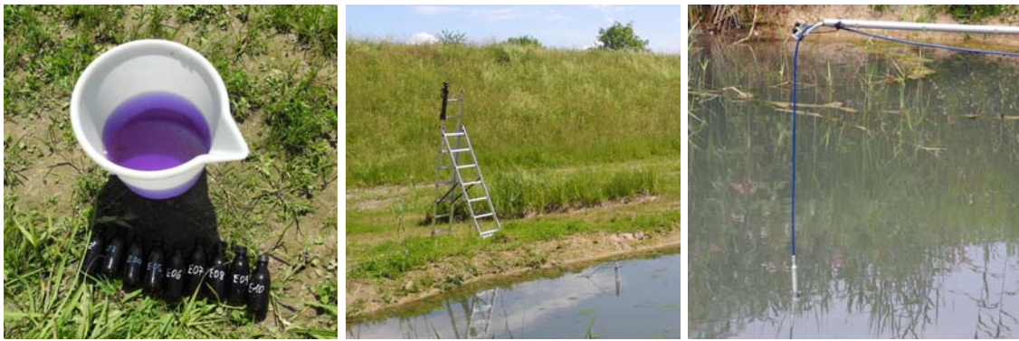
Abbildung 3.4: Ergänzende Untersuchungen. Links: Eimer mit einem kleinen Rest des eingespeisten Tracer-Cocktails unter direkter Sonneneinstrahlung. Mitte: Montage der Kamera für die Fotodokumentation des Tracerdurchgangs im Teich. Rechts: An einer Angel befestigte Br-Sonde zur Aufnahme von Tiefenprofilen (Foto: J. Lange)
