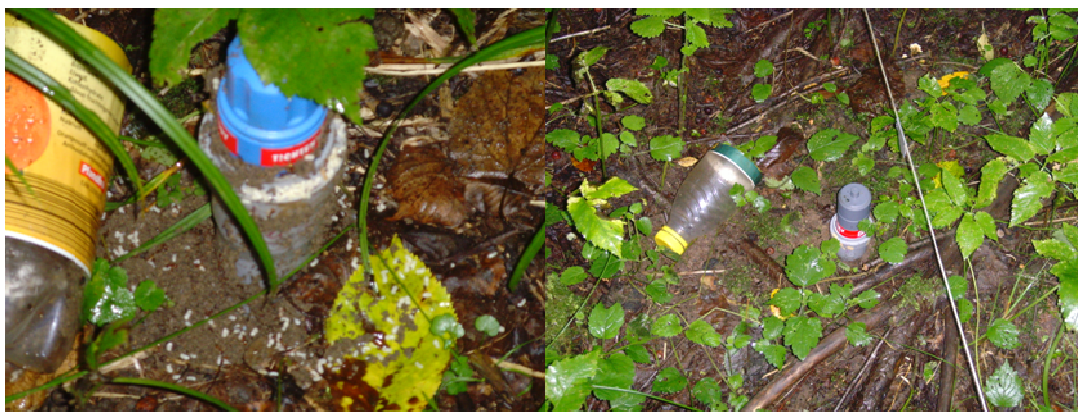
Abbildung 4.5 Odyssey Water Capacitive Rekorder im Gelände. Der Blaue ist einer der neuen Odysseys und der graue ist ein älterer. Bei dem Blauen ist auch ein Ameisennest zu sehen, dass sich in der Abdeckung (halbe PET-Flasche) gegründet hat.
