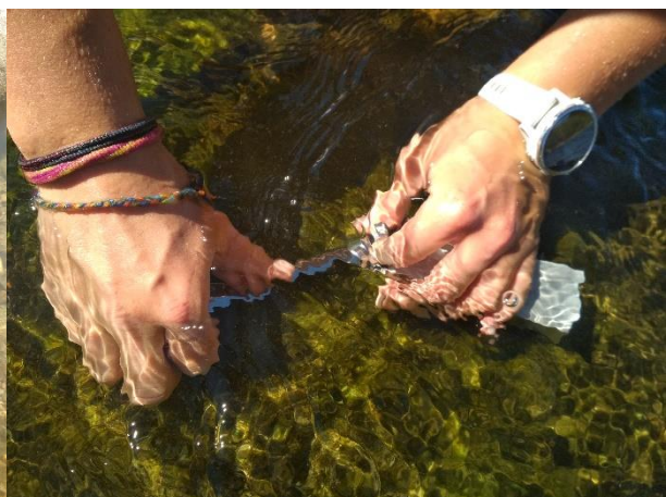
Abbildung A9: Montage eines Hobos durch Spreizdübel
