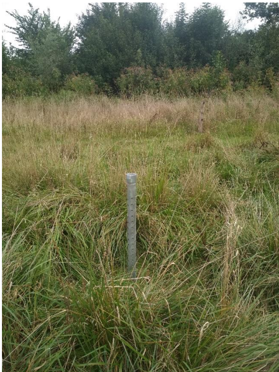
Abbildung A12: Rammfilter der Messtelle GW4
