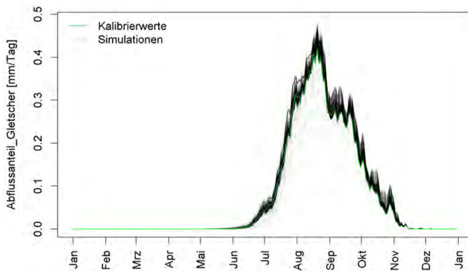
Abbildung A.5: Abflussregime der Gletscherschmelze der Simulationen, gemessenen Abflüsse und dem Kalibrierwert. Ergebnisse für das EZG Engelberger Aa.
