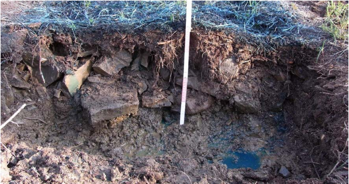
Abbildung A6: Aufgegrabenes Profil des Brilliant Blue Plots Nr. 4 am Nordhang.
