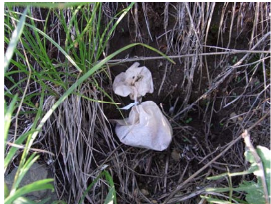
Abbildung 4.2: Mit Tracer gefüllte Teebeutel zur Ausbringung des Tracers, mit verminderter Gefahr eines aerosiven Transportes.
