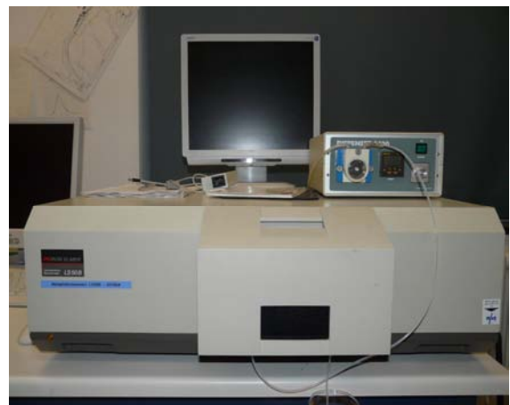
Abbildung 4.7: Verwendetes Fluoreszenzfotometer von PerkinElmer.
