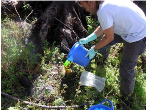
Abbildung 4.10: Uranineinspeisung am 20. Juni um 17:40 Uhr.
