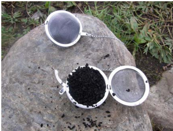
Abbildung 4.1: Mit Aktivkohle gefüllte Teeeier, wie sie im Gelände ausgebracht wurden.
