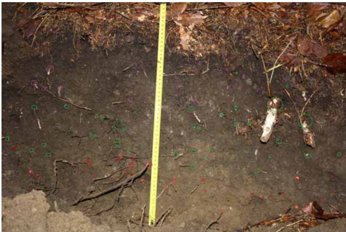
Abbildung 7.8.1: Darstellung des Vorgehens zur Abschätzung der vertikalen Makroporendichte an Standort K4.
