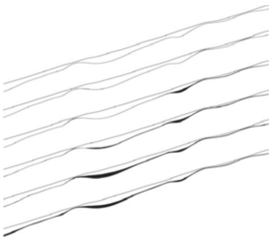
Abbildung 2.3.2: Schematische Darstellung der „fill and spill“ Theorie. Die geschwärzten Bereiche kennzeichnen gesättigte Bereiche (Tromp-van Meerveld & McDonnell, 2006).
