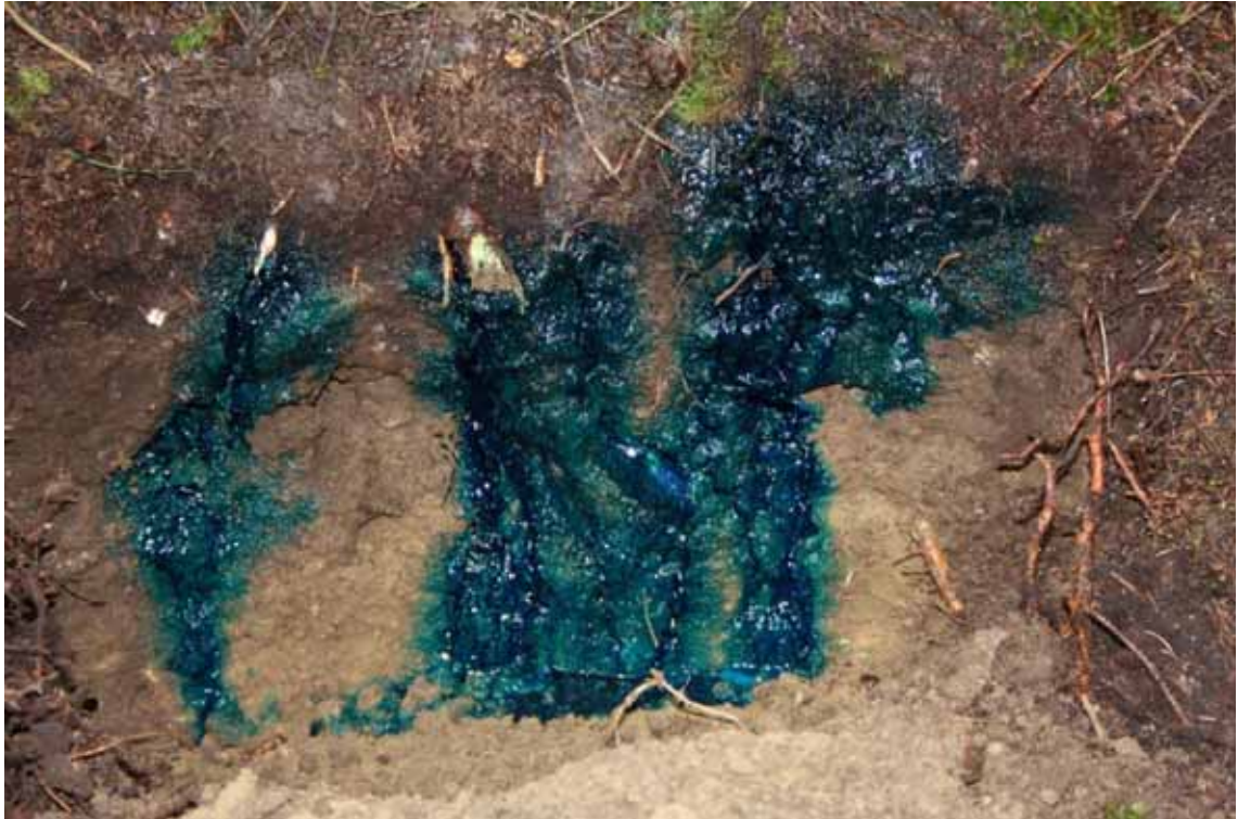
Abbildung 9.6.2: Aufnahme des offengelegten Profils an Standort K5 nach ca. 20min Beregnungszeit.
