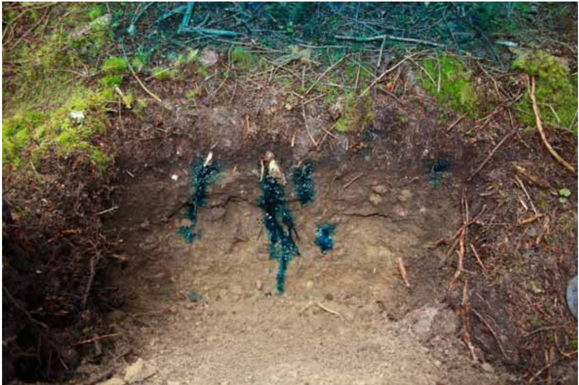
Abbildung 9.6.1: Aufnahme des offengelegten Profils an Standort K5 nach ca. 10min Beregnungszeit.
